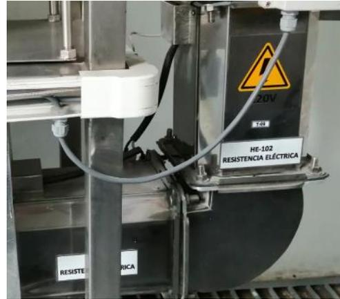
**Nota.** En la figura 25 se evidencia la fotografía de la configuración de resistencias eléctricas del sistema HE-401 y HE-402 del equipo en planta que corresponde al secador de bandejas.
