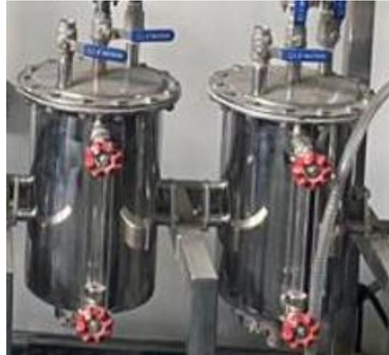
**Nota.** En la figura 20 se evidencia la fotografía de los tanques colectores de solvente TK-302 Y TK-303 del equipo en planta que corresponde al extractor multipropósito.
