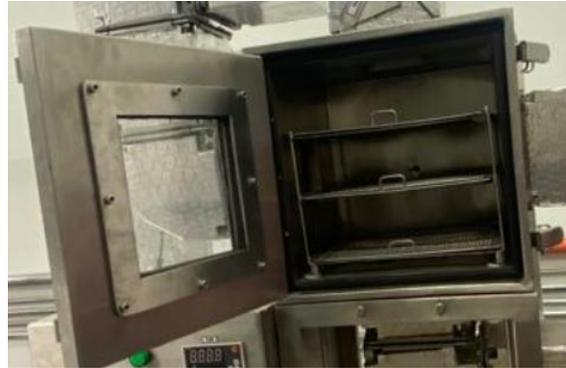
*Nota.* En la figura 25 se evidencia la fotografía de la cámara de secado abierta DC-401 en del equipo en planta que corresponde al secador de bandejas.
