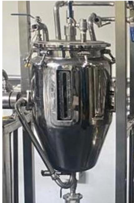
**Nota.** En la figura 12 se evidencia la fotografía del percolador R-301 del equipo en planta que corresponde al extractor multipropósito.
