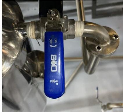
*Nota.* En la figura 37 se evidencia la fotografía que representa las válvulas de bola instaladas en los equipos del CEPIIS.
