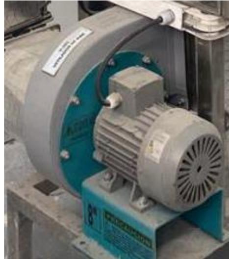
**Nota.** En la figura 32 se evidencia la fotografía del ventilador centrífugo F-401 en del equipo en planta que corresponde al secador de bandejas.
