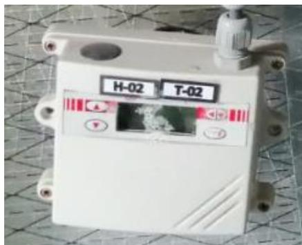
**Nota.** En la figura 35 se evidencia la fotografía que representa los higrómetros instalados en el equipo de secado del CEPIIS
