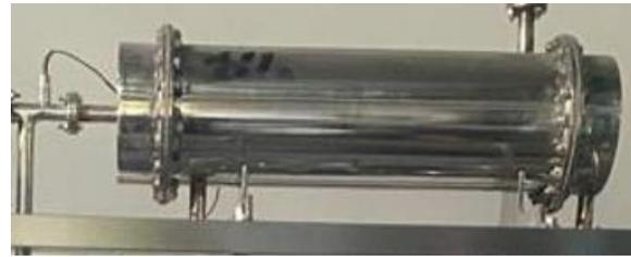
**Nota.** En la figura 14 se evidencia la fotografía del condensador E-301 del equipo en planta que corresponde al extractor multipropósito.
