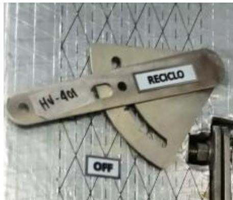
*Nota.* En la figura 38 se evidencia la fotografía que representa las válvulas dámper instaladas en el equipo de secado del CEPIIS
