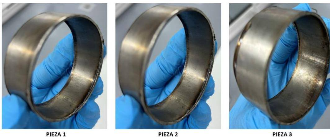
**Nota.** La figura muestra 3 piezas de acero inoxidable 316 en el cual se va a realizar las pruebas de electropulido donde se permita identificar un cambio visual de apariencia.
