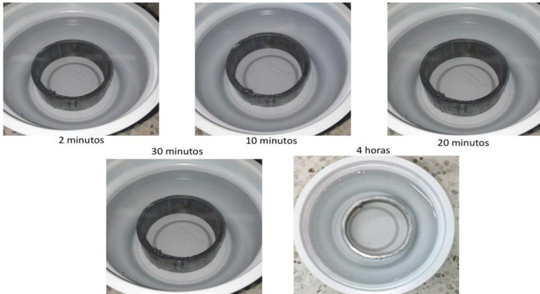
**Nota.** La figura muestra los resultados de pruebas por contacto de corrosión en la tubería de acero galvanizado al ser expuesta a la solución EcoDes (Acido Hipocloroso).
