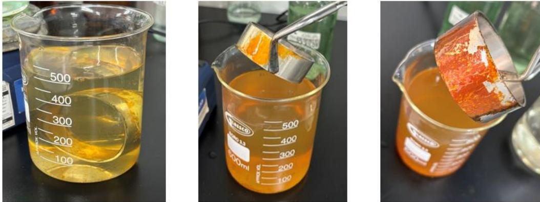
**Nota.** Las piezas después de ser extraídas de la celda de electrolisis y estar en contacto con el oxígeno del ambiente se evidencia una capa de corrosión en la superficie.
