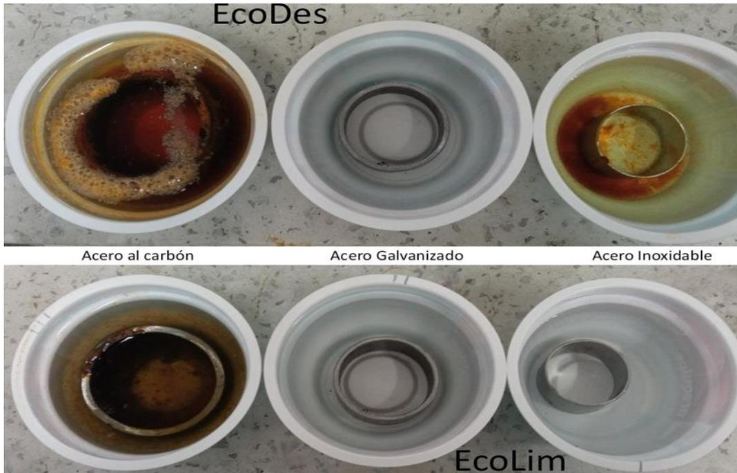
**Nota.** La figura muestra los resultados de corrosión en la superficie de las tuberías después de un tiempo de 5 días, en los dos tipos de insumos usados (EcoLim y EcoDes) y los respectivos materiales usados: acero al carbón, acero galvanizado y acero inoxidable.
