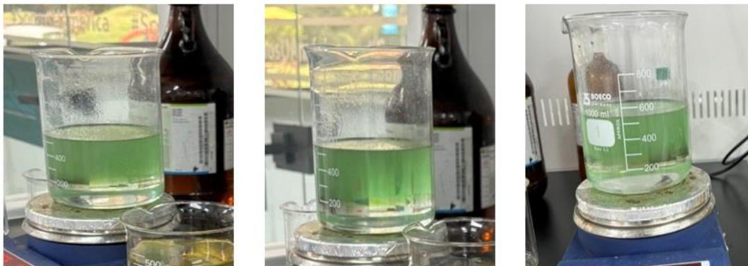
**Nota.** Las soluciones después de un proceso de electrolisis presentan una coloración con una variación visual de densidades entre los productos que genera una separación de materiales en el vaso precipitado.
