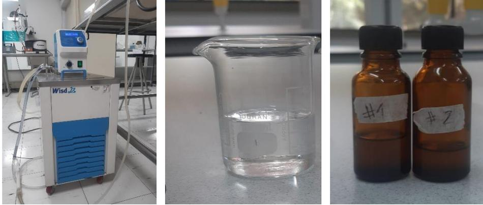
**Nota.** En las siguientes imágenes se evidencia el proceso para obtener AE por medio de soxhlet contando izquierda a derecha y luego abajo, a. Naranja obtenida para la extracción, b. secado en horno del flavedo c. Desecador para retirar humedad d. muestra obtenida para extraer AE e. Montaje soxhlet f. Rotaevaporador para separar el solvente del aceite g. chiller para refrigerar el proceso h. Solvente recuperado i. Frascos tipo ámbar con AE.
