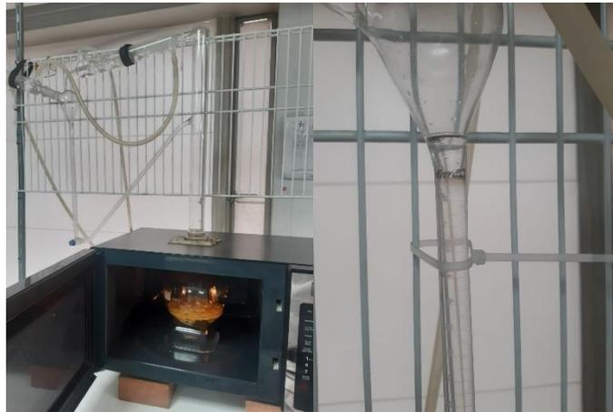
**Nota.** En las siguientes imágenes se evidencia el proceso para obtener AE por medio de HAM contando izquierda a derecha a. Montaje de HAM, b. AE separado del agua.
