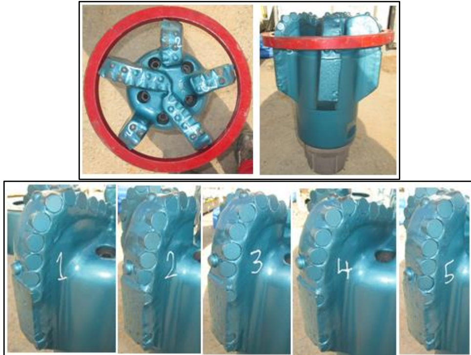
Figura 52. Broca con calibre extendido reparada pozo CA471.
