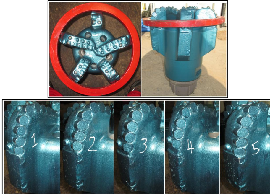
Figura 49. Broca con calibre extendido nueva pozo CA236.
