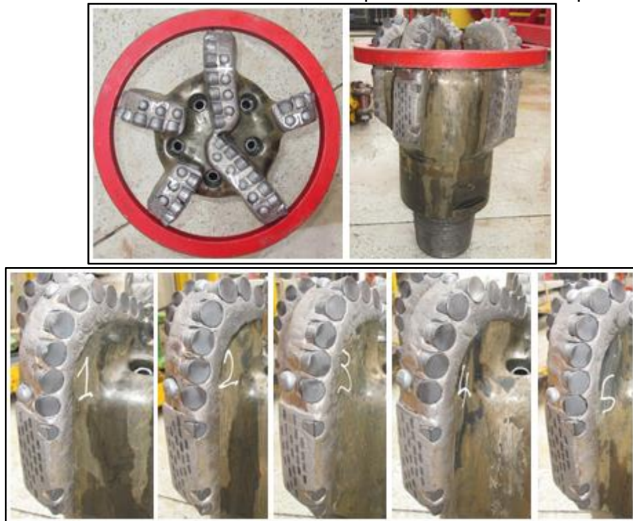
Figura 53. Broca con calibre extendido después de corrida en el pozo CA471.
