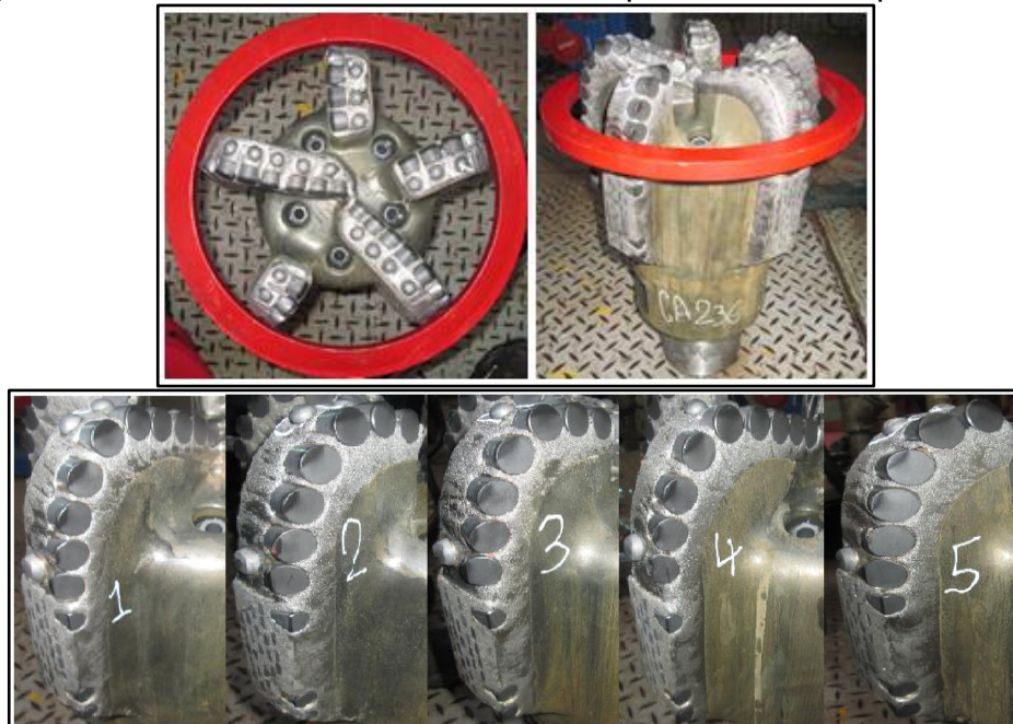
Figura 50. Broca con calibre extendido después de corrida pozo CA236.
