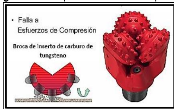
Figura 4. Falla por esfuerzo de compresión.
