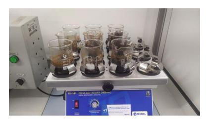
**Nota.** La figura representa la agitación de las muestras en la mesa agitadora orbital.
