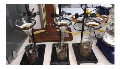
**Nota.** La figura representa la filtración de las muestras pretratadas con NaOH
