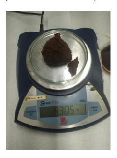
**Nota.** La figura representa la muestra de lignina filtrada, lavada con agua destilada y secada hasta obtener el peso constante de 78,38 gramos.
