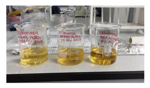
**Nota.** La figura representa el fluido extraído de la biomasa del vástago de plátano después de la hidrólisis ácida. El color se debe al contenido, pues, es azúcares fermentables producto del pretratamiento y tratamiento con NaOH y H<sub>2</sub>SO<sub>4</sub>, respectivamente.
