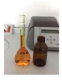
**Nota.** La figura representa la producción del reactivo DNS para efectuar la cuantificación de azúcares reductores.
