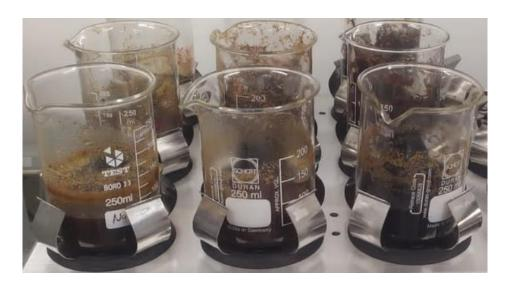
*Nota.* La figura representa los seis ensayos de la malla 70 dentro de las cavidades de la plancha.
