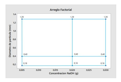
**Nota.** En la gráfica se esclarece el arreglo factorial dimensional del diseño experimental 3x3, en la cual, se toma la interacción ejecutable entre el factor A (Concentración de NaOH) y el factor B (Diámetro de partícula) dibujando bloques lineales al conectarse entre puntos, pero, difieren entre cada interacción AB reflejado en los resultados.
