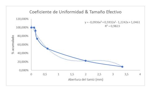
**Nota.** En la gráfica se halló coeficiente de uniformidad y el tamaño efectivo al estar relacionado por el porcentaje acumulado y la abertura del tamiz. Al utilizarse tamices de abertura pequeña, se logró retener gran cantidad de material debido a la molienda y pulverización del vástago de plátano, logrando un diámetro de partícula pequeño y el bajo uso del reactivo NaOH.
