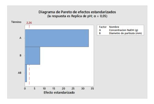
**Nota.** En este diagrama se ilustra la relación – interacción entre los factores A, B y AB sobre la variable de respuesta. En el diagrama de Pareto se ilustra el efecto del factor A, B y AB respecto a la variable de respuesta con un Alpha equivalente a 0,05. Se evidencia la importancia que genera el factor A y B al sobrepasar el umbral 2,26. Sin embargo, el factor AB como interacción, no causa mayor influencia sobre la variable de respuesta.
