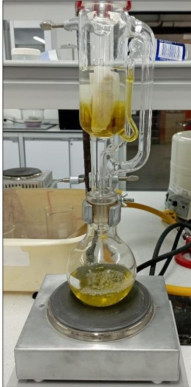
*Nota. La figura muestra el resultado del segundo ciclo del proceso de extracción de aceite esencial por el método de destilación con solvente.*
