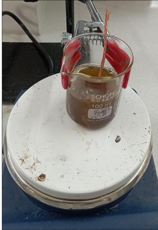
*Nota. La figura muestra la primera prueba de corrosión realizada con el aceite lubricante formulado a la temperatura de 100°C.*
