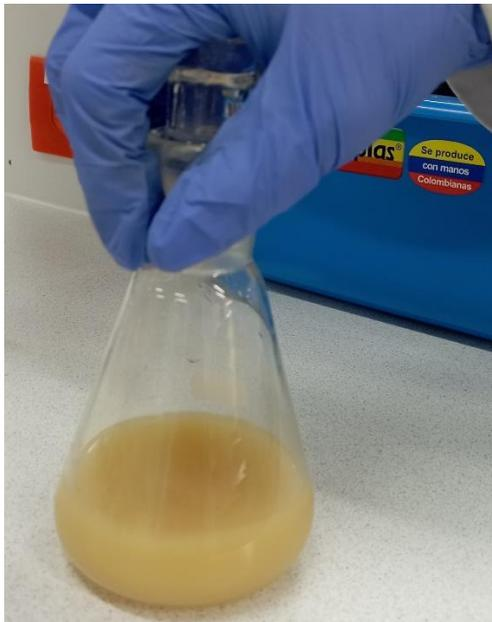
*Nota. La figura muestra el resultado del ensayo para la determinación de índice de peróxidos en el aceite esencial de naranja obtenido.*
