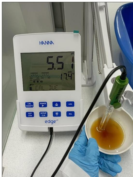
*Nota. La figura muestra resultado de la lectura de pH con el equipo pHmetro.*
