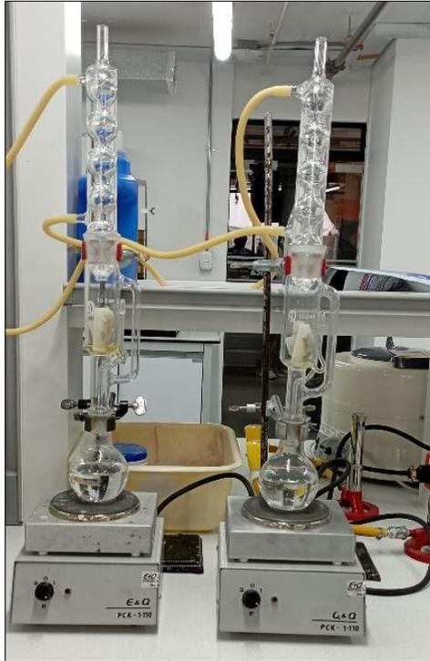
*Nota.* La figura muestra los montajes adicionales realizados para la extracción de aceite esencial por el método de destilación con solvente.
