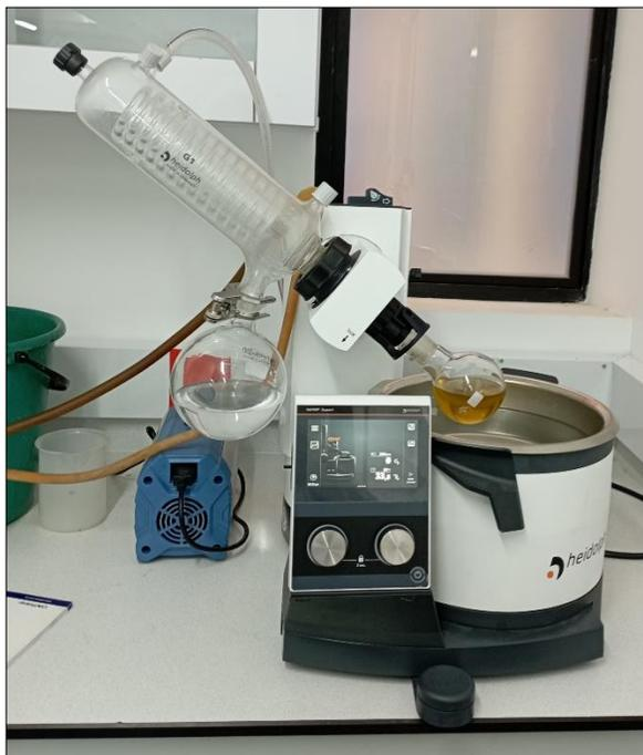
*Nota. La figura muestra el equipo usado para la separación del destilado obtenido del proceso anterior de extracción con solvente.*
