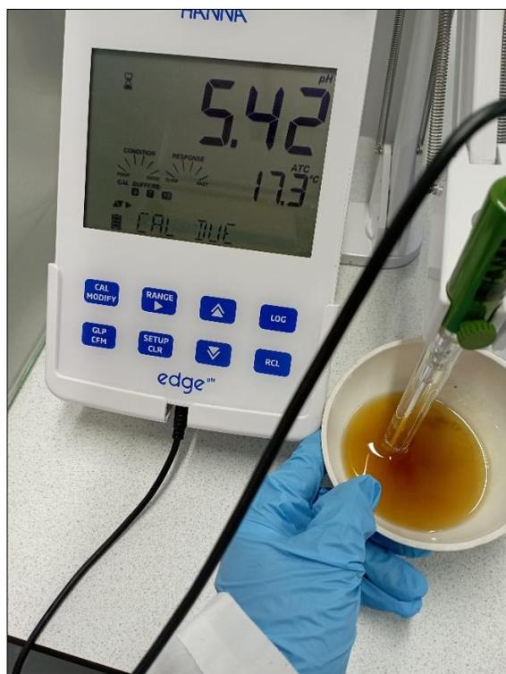
*Nota. La figura muestra el segundo resultado de la lectura de pH con el equipo pHmetro.*
