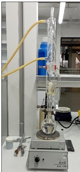
*Nota. La figura muestra el montaje con los equipos necesarios para la extracción de aceites esenciales por el método de destilación con solvente de arriba hacia abajo condensador, digestor soxhlet, balón de destilación y plancha de calentamiento.*
