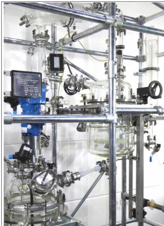
*Nota. La figura muestra la representación del extractor sólido-líquido que será el equipo con el cual se obtendrá el aceite esencial de naranja. Tomado de: De Dietrich process systems. [En línea] Disponible: <https://www.dedietrich.com/es/soluciones-y-productos/extraccion/extraccion-solido/liquido> [Accedido: May.29, 2023]*
