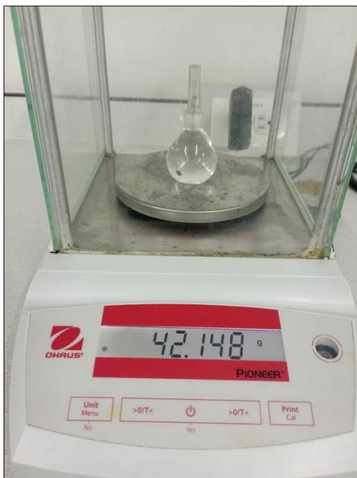
*Nota. La figura muestra el resultado al pesar el picnómetro con agua.*
