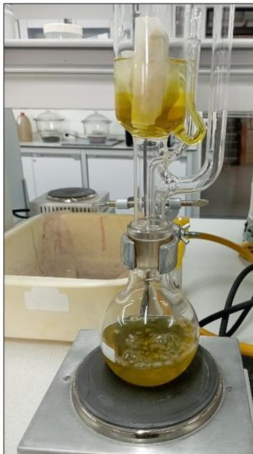
*Nota. La figura muestra el resultado del segundo ciclo del proceso de extracción de aceite esencial por el método de destilación con solvente.*
