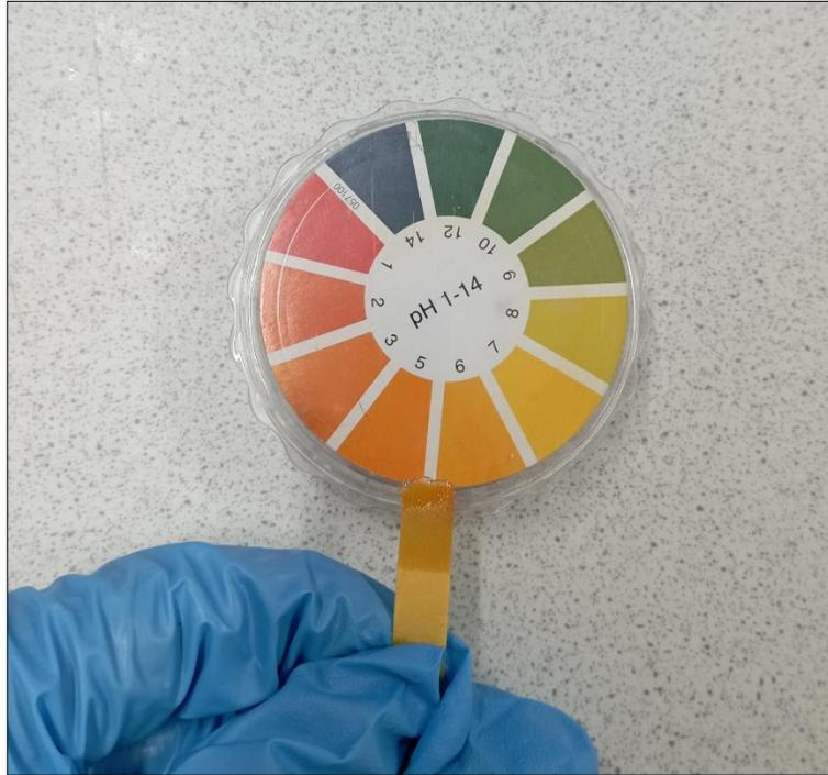
**Nota.** la figura muestra la comparación del pH tomado del aceite lubricante formulado con la guía del empaque del papel tornasol.
