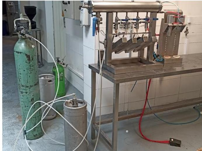
*Nota:* Se muestran los equipos usados en la carbonatación y embotellado.
