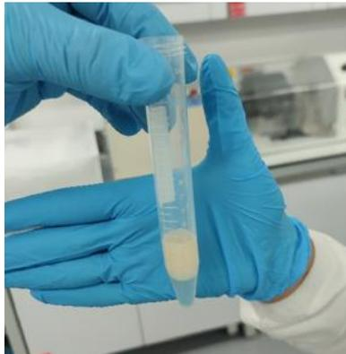
*Nota. PHB con cloroformo precipitado en tubo falcon.*
