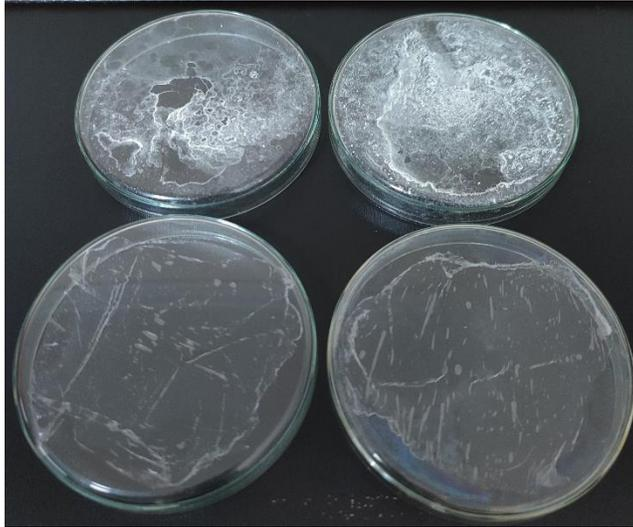
*Nota. Film adherente y PHB obtenido experimentalmente adheridos en cajas Petri.*
