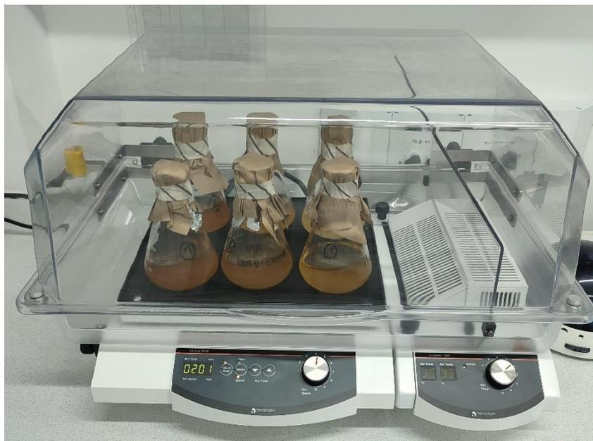
*Nota. Montaje de fermentación en Shaker a 35 °C y 200 rpm.*
