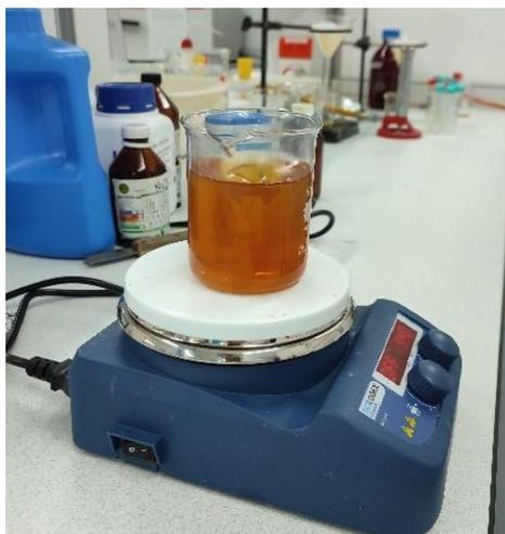
*Nota. Proceso de decoloración manteniendo agitación constante con un agitador orbital.*
