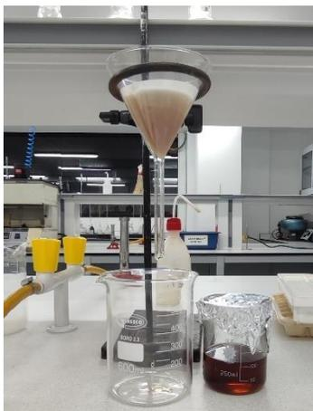
*Nota. Filtración de la muestra por gravedad.*
