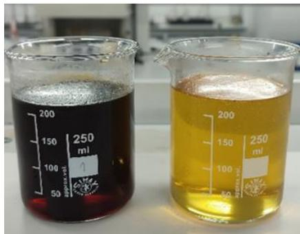
*Nota. Glicerol crudo Bio D vs Glicerol Crudo BioD purificado.*
