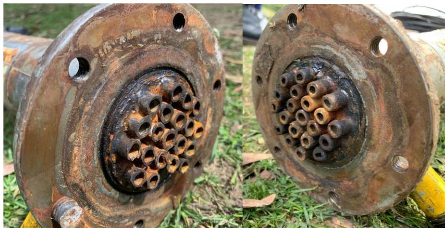
**Nota.** Fotografía tomada en el año 2022 que evidencian las incrustaciones, óxido, corrosión al interior de los tubos y en la superficie de los flanges de la coraza, adicionalmente se evidencia que los empaque que sellaban las tapas ya no están presentes.
