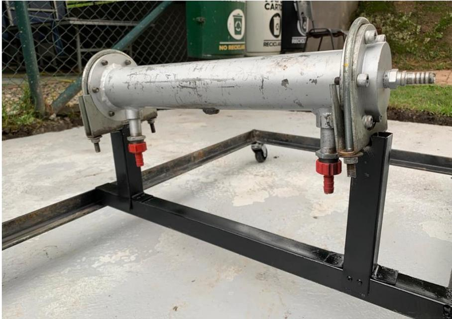
*Nota.* Soporte o base del condensador ya ensamblado junto con el condensador.
