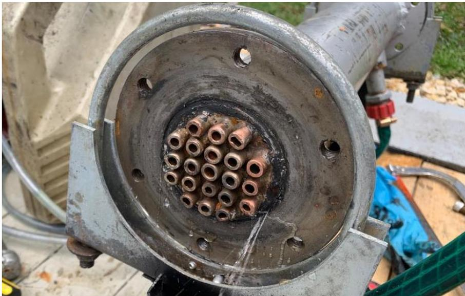
*Nota.* Fugas de agua presentes en el sistema de refrigeración al realizar pruebas de hermeticidad.
