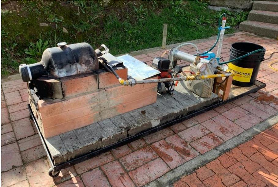
*Nota.* En las fotografías se evidencia el reemplazo de mangueras por tubos galvanizados, estos van desde la salida del reactor hasta la entrada del condensador, y desde el condensador hasta la recirculación de los gases no condensables para alimentar la fase de calentamiento del reactor.
