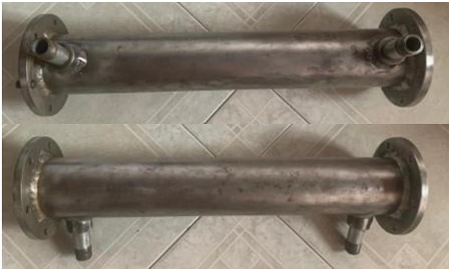
**Nota.** La coraza del intercambiador se encuentra sin pintura y sin rastros de óxido, lista para aplicar capas de pintura.
