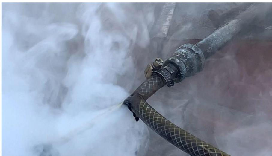
*Nota.* Debido a las altas temperaturas del gas de pirólisis la manguera que se encontraba a la salida del reactor se derritió generando una fuga de todo el producto.
