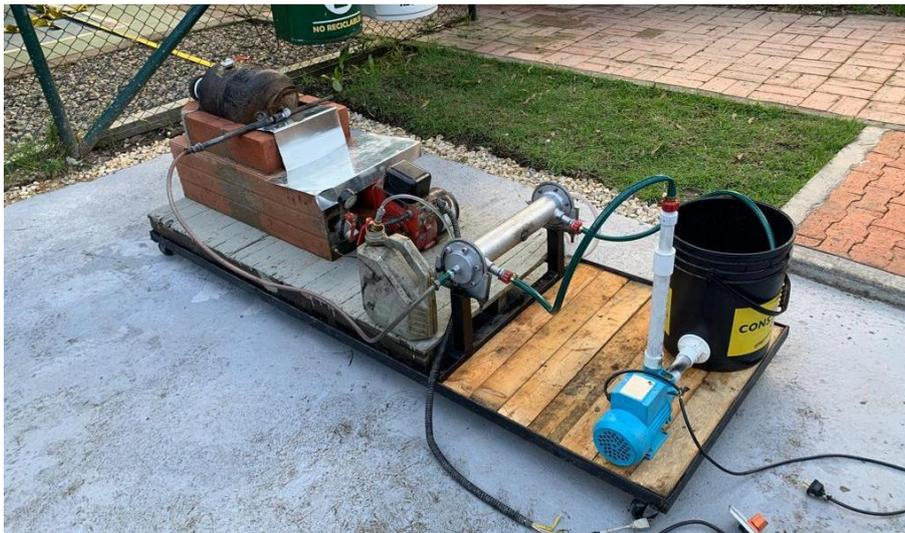
*Nota.* El banco de pruebas de pirólisis de neumáticos usados con todos sus componentes listos y conectados, estos son el tanque de agua, la motobomba encargada de recircular el fluido refrigerante (Agua), el reactor de pirólisis, el lanzallamas diésel, y otros elementos de apoyo.
