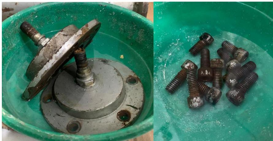
*Nota.* Componentes y accesorios del intercambiador de calor sumergidos en vinagre.
