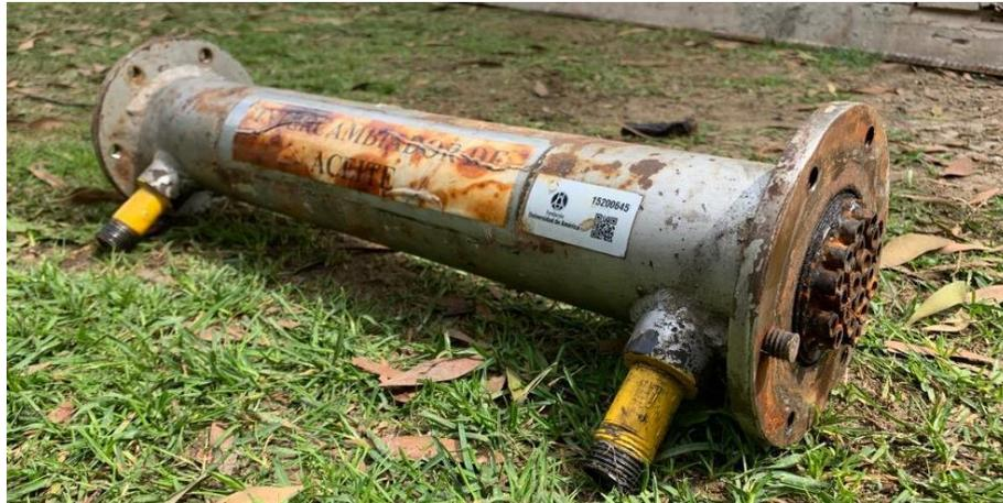
**Nota.** Fotografía tomada en el año 2022 de las condiciones en las que se encontraba el intercambiador de calor del sistema de enfriamiento didáctico una vez se desmontó del banco y se retiraron las tapas laterales.
