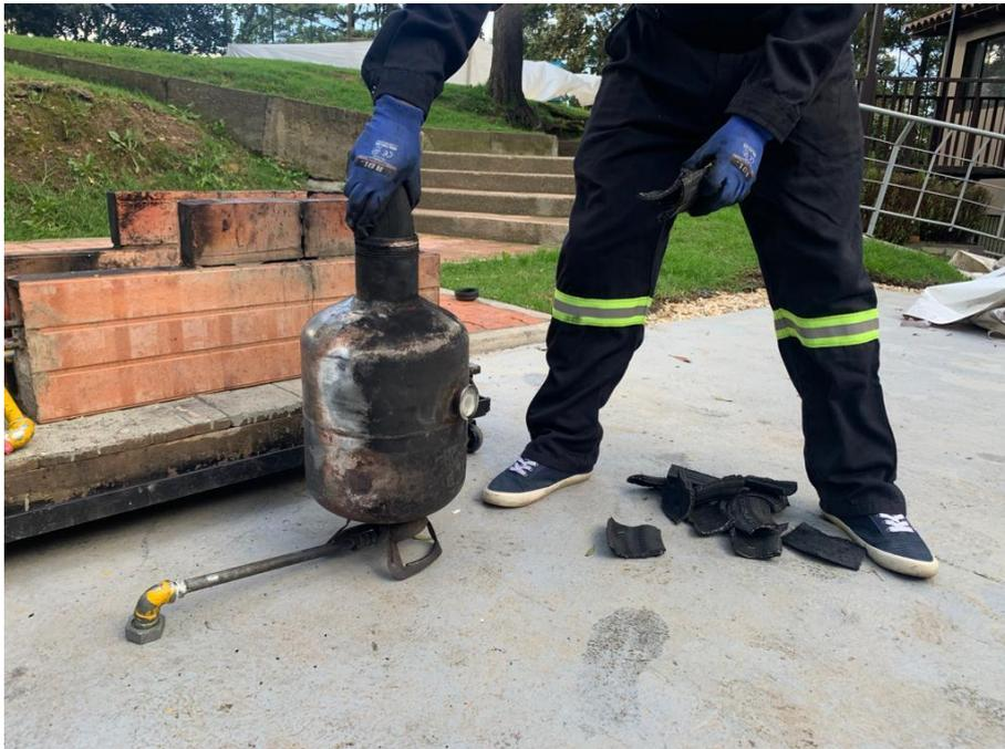
**Nota.** Cortes de neumáticos usado siendo introducidos al interior del reactor de pirólisis para iniciar la prueba de funcionamiento y operación.
