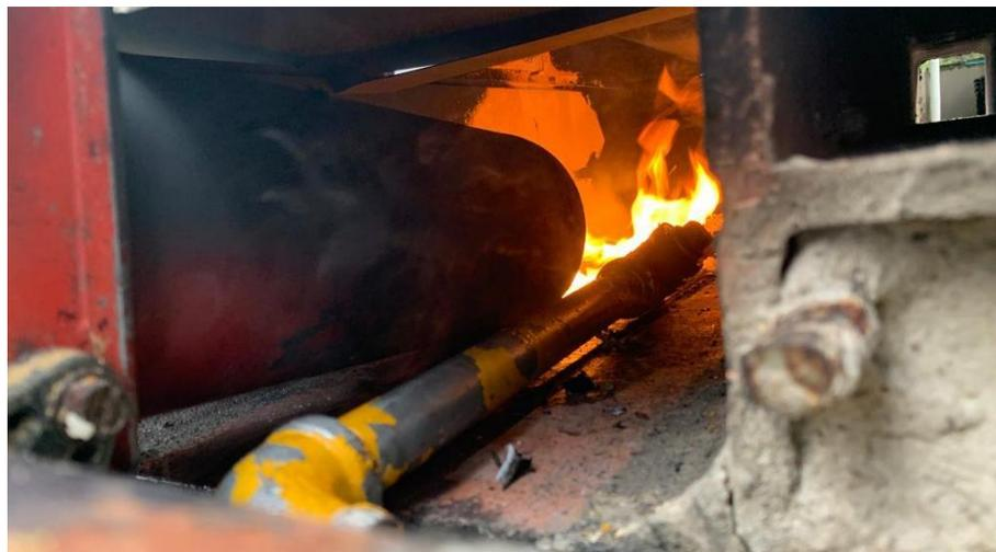
*Nota.* Los gases de pirólisis no condensables son nuevamente aprovechados al ser recirculados para apoyar el proceso de calentamiento del reactor, sin embargo, la cantidad de energía aportada no es la suficiente para sustituir por completo la energía aportada por el lanzallamas Diesel.
