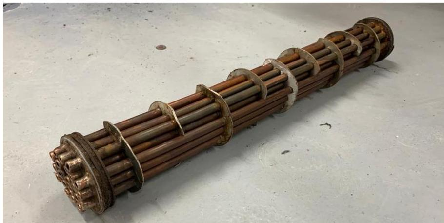
**Nota.** Fotografía del haz de tubos del intercambiador de calor.
