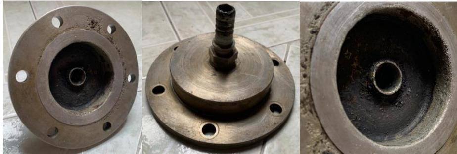
*Nota.* Fotografías que evidencian el estado en el que estaban las tapas laterales del intercambiador de calor.
