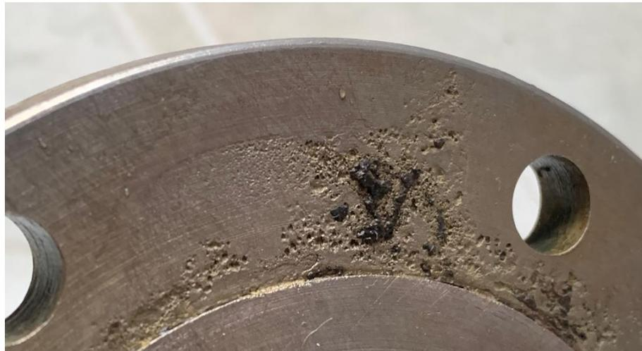
*Nota.* Corrosion presente en la superficie de las tapas laterales del intercambiador de calor.
