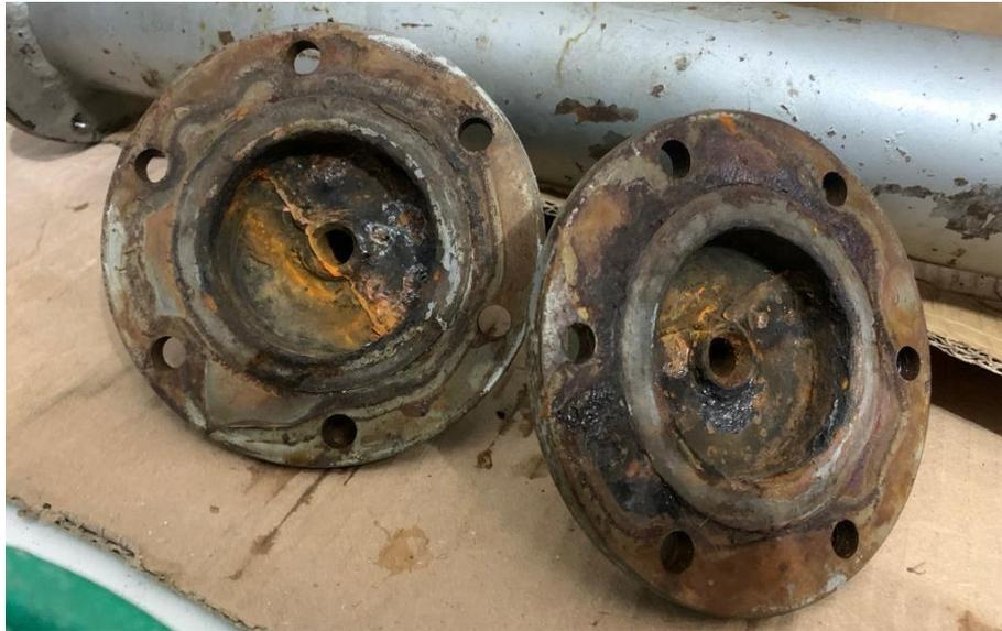
**Nota.** Fotografía de las tapas laterales del haz de tubos del intercambiador de calor.
