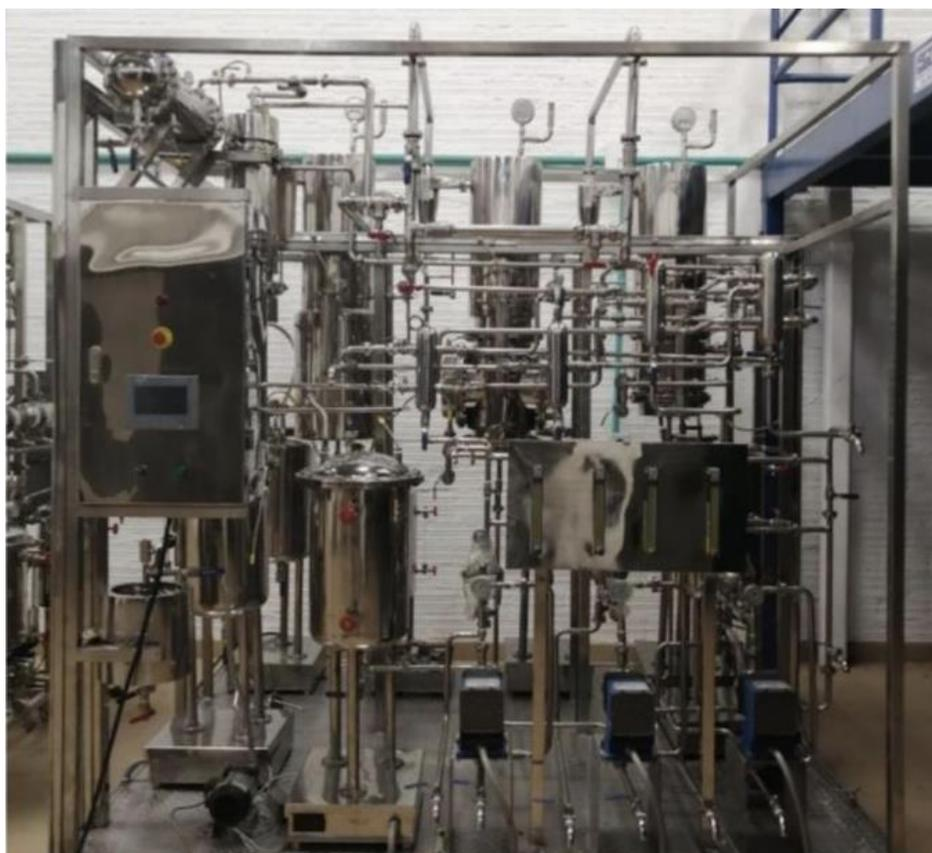
**Nota:** En la figura se evidencia una fotografía del tren de evaporadores del del centro de transformación y adecuación (CETA). Tomado de [“PRODUCTOS Y SERVICIOS |PROCESS SOLUTIONS AND EQUIPMENT.” <https://andreaorjuela.wixsite.com/website/productos-y-servicios> (accessed Jun. 06, 2022)]
