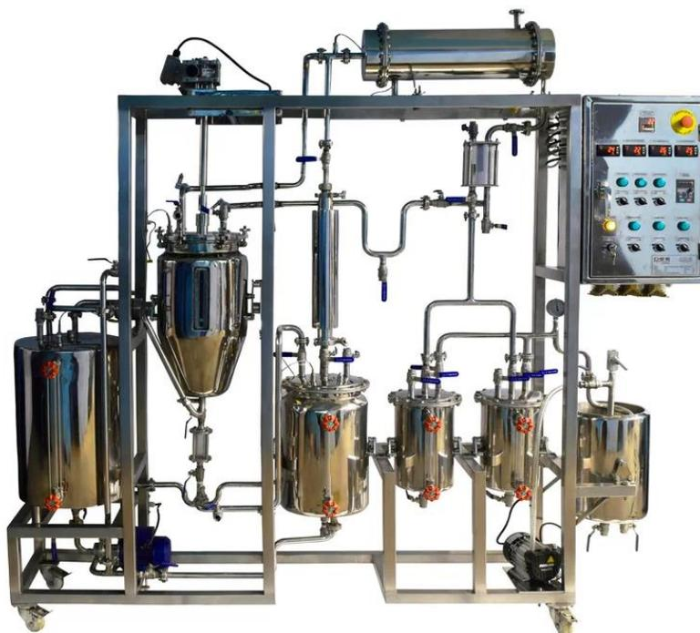
**Nota:** En la figura se evidencia una fotografía del extractor líquido-líquido y sólido-líquido del Centro de purificación y refinación de producto (CEPURE). Tomado de [“PRODUCTOS Y SERVICIOS [PROCESS SOLUTIONS AND EQUIPMENT.” <https://andreaorjuela.wixsite.com/website/productos-y-servicios> (accessed Jun. 06, 2022)]
