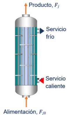
**Nota:** En la figura se evidencia la operación de un reactor PFR, con servicio frío y caliente. Tomado de [PSE, “MANUAL DE OPERACION BANCO DE REACTORES,” 2018]
