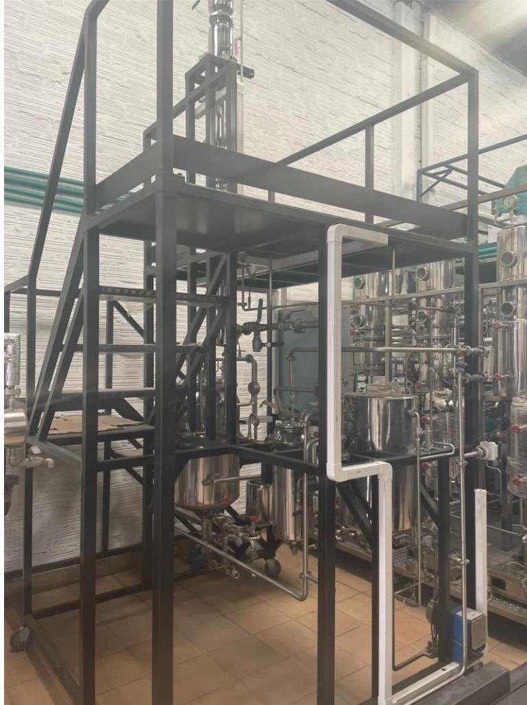
**Nota:** En la figura se evidencia una fotografía de la columna de absorción del Centro de purificación y refinación de producto (CEPURE). Tomado de [“PRODUCTOS Y SERVICIOS |PROCESS SOLUTIONS AND EQUIPMENT.” <https://andreaorjuela.wixsite.com/website/productos-y-servicios> (accessed Jun. 06, 2022)]
