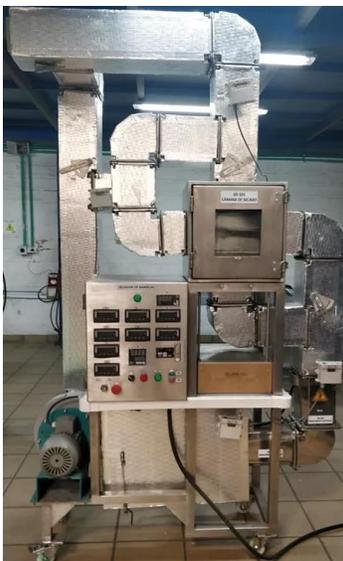
**Nota:** En la figura se evidencia una fotografía del secador de bandejas del Centro de purificación y refinación de producto (CEPURE). Tomado de [“PRODUCTOS Y SERVICIOS |PROCESS SOLUTIONS ANDEQUIPMENT.”<https://andreaorjuela.wixsite.com/website/productos-y-servicios> (accessed Jun. 06, 2022)]
