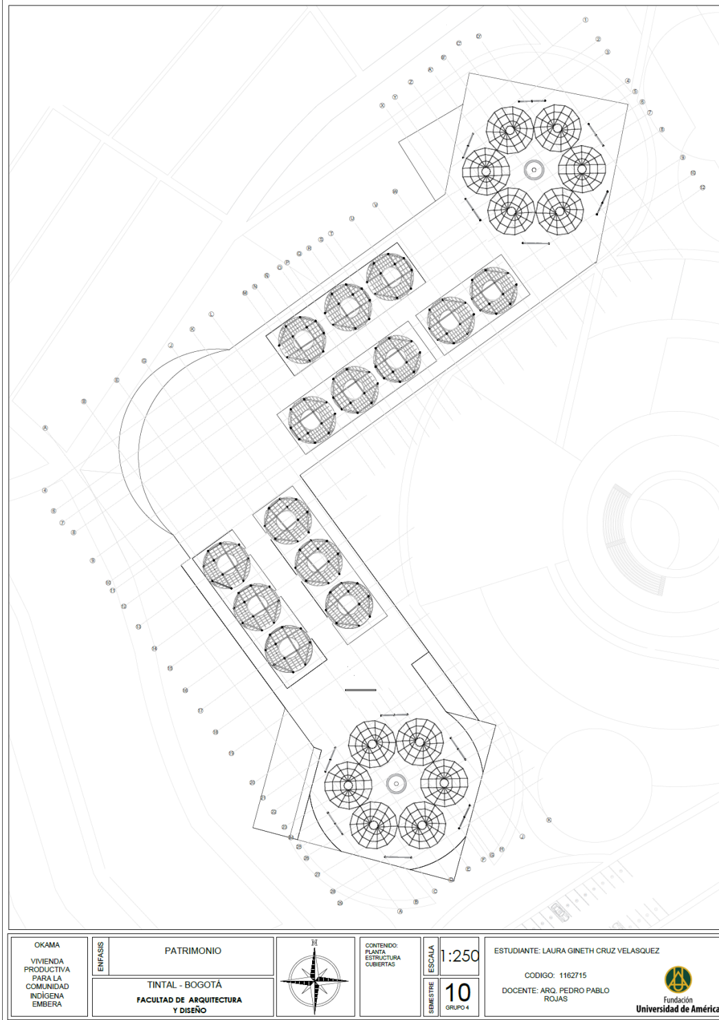
Planta estructural cubierta
