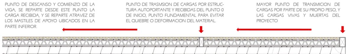
“Es un mecanismo formado por un voladizo corto con preponderancia de transferencia de esfuerzos por ménsula corta o esfuerzo directo por biela comprimida al apoyo (mínima flexión) y con una contra ménsula vinculada a otro punto que genere el equilibrio del conjunto.”<sup>8</sup>
