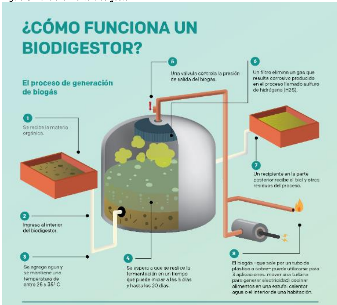
Figura 6. Funcionamiento biodigestor.
