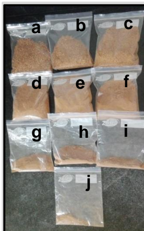
Imagen 31. Distribución de la semilla por No. de Tamiz. a) No. 12, b) No. 14, c) No. 16, d) No. 20, e) No. 30, f) No. 40, g) No. 50, h) No. 70, i) No. 80 y j) No. 100.
