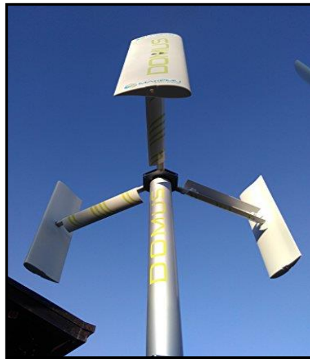
Figura 4. Modelo Darrieus H de tres palas.
