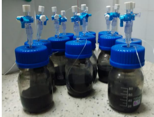
Ilustración 19. Botellas de ensayo con lodos activados en un medio anaeróbico.
