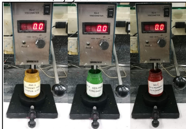
Ilustración 27. Toma de viscosidad para óxido de hierro amarillo, rojo y cromo verde.
