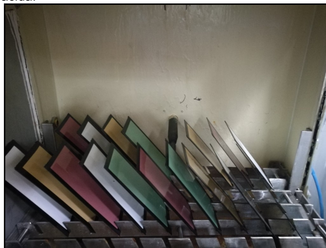
Ilustración 32. Aplicaciones expuestas a cámara lluvia ácida.
