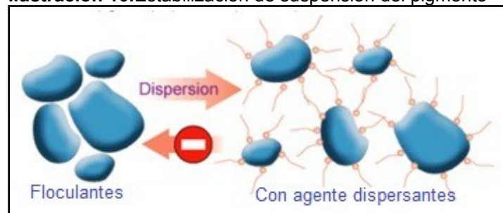
Ilustración 10. Estabilización de suspensión del pigmento
