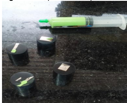
Figura 32. Aplicación de pasta de diamante a la probeta
