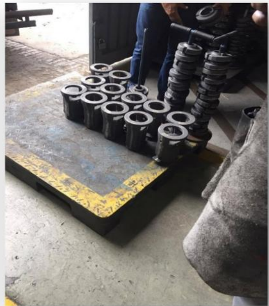
Figura 11: Materia Prima fundida en hierro de bastidores para bombas centrifugas.
