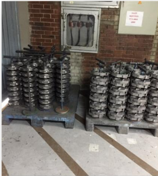
Figura 12: Materia Prima fundida en hierro de impulsores y difusores para bombas Multi etapas
