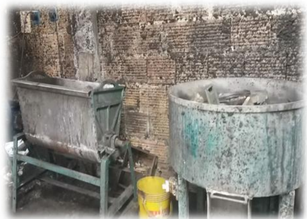
Figura 7: Herramientas y tanques de mezcla de la colada
