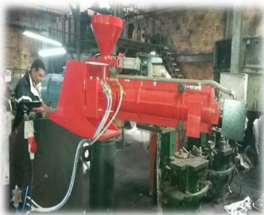
Figura 8: Prensadora de moldes de arena para fundir
