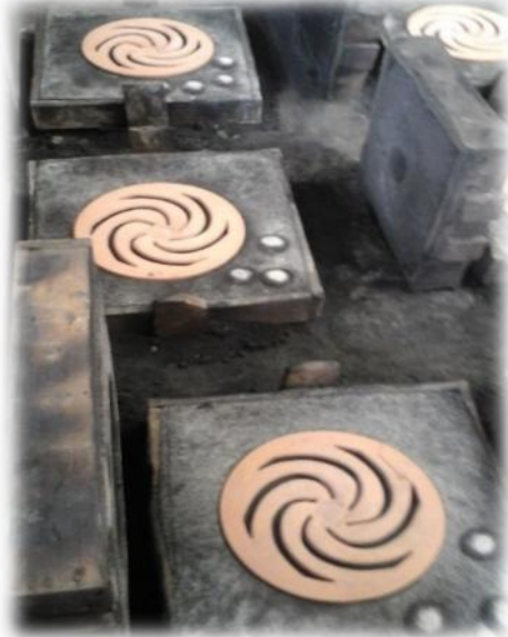
Figura 5 Moldes de arena de impulsores de bomba multi etapa
