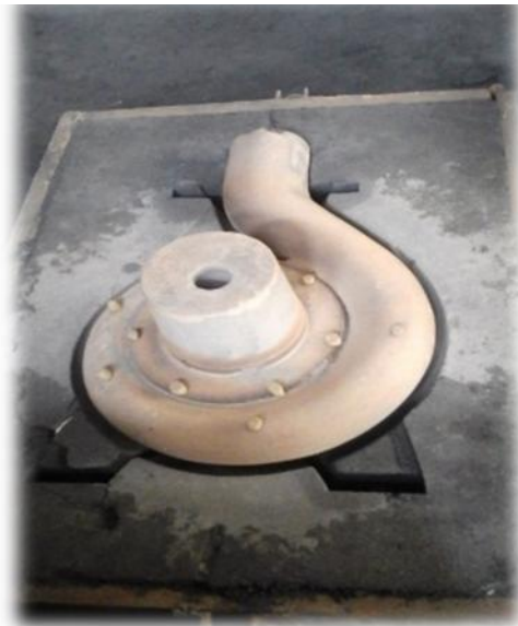
Figura 4. Molde de arena de una Voluta de una bomba centrífuga.
