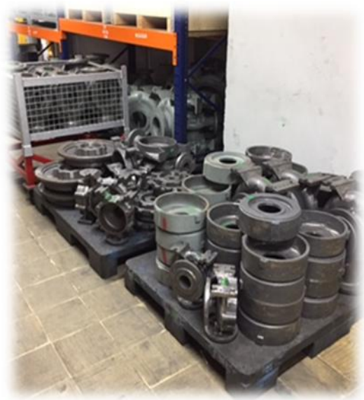
Figura 13 Materia Prima de hierro almacenada en cestas “Cuerpos, volutas y bastidores”
