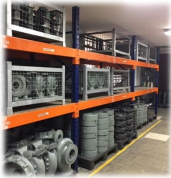
Figura 14 Materia Prima de hierro almacenada en cestas “Cabezales de succión y descarga e impulsores”
