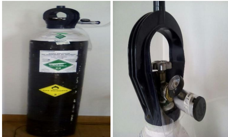
Figura 24. Cilindro de CO 2 y regulador de flujo
