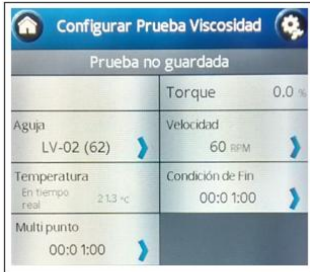
Figura 17. Condiciones de análisis viscosímetro Brookfield DV.
