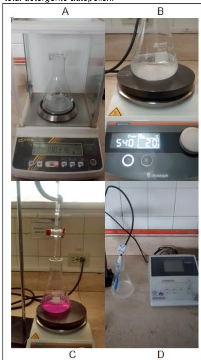
Figura 23. Determinación alcalinidad libre y total detergente autopolish.
