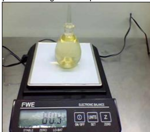
Figura 13. Medición actual de la densidad para el detergente autopolish.
