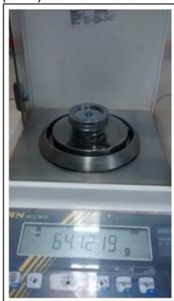
Figura 21. Pesaje del picnómetro con muestra (PPM).
