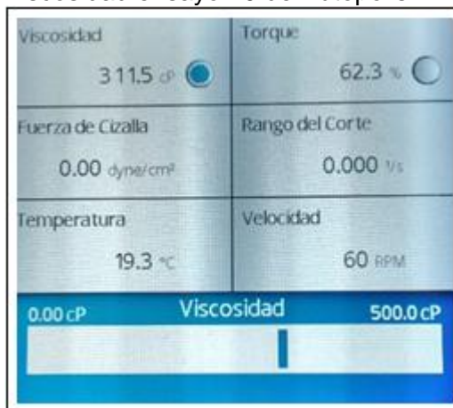
Figura 19. Resultado análisis de viscosidad ensayo 10 de Autopolish.
