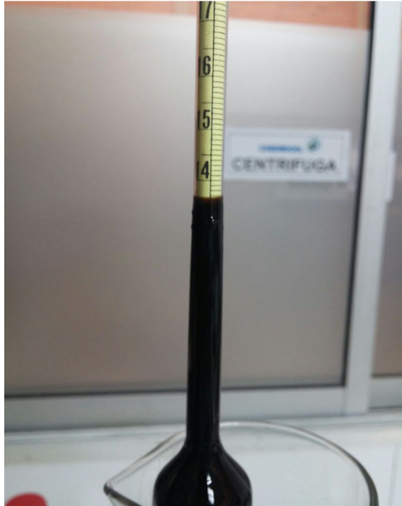
Figura 12. Lectura de la gravedad API de la muestra en hidrómetro.
