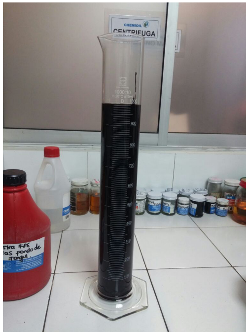
Figura 8. Muestra de 1000 mL para prueba de gravedad API con Hidrómetro.
