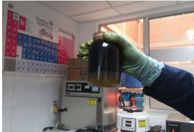
Figura 7. Separación de una Emulsión por Segregación Gravitacional.
