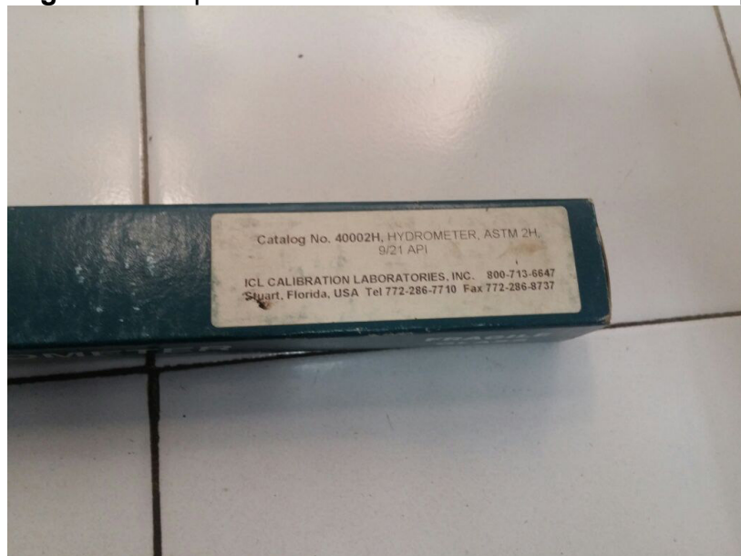
Figura 10. Especificaciones del hidrómetro usado en la prueba.
