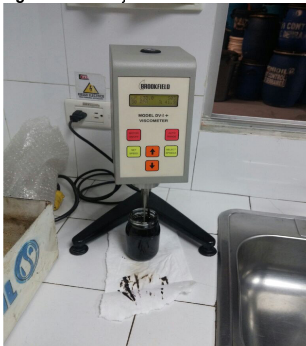
Figura 16. Montaje de Prueba con Viscosímetro Brookfield.
