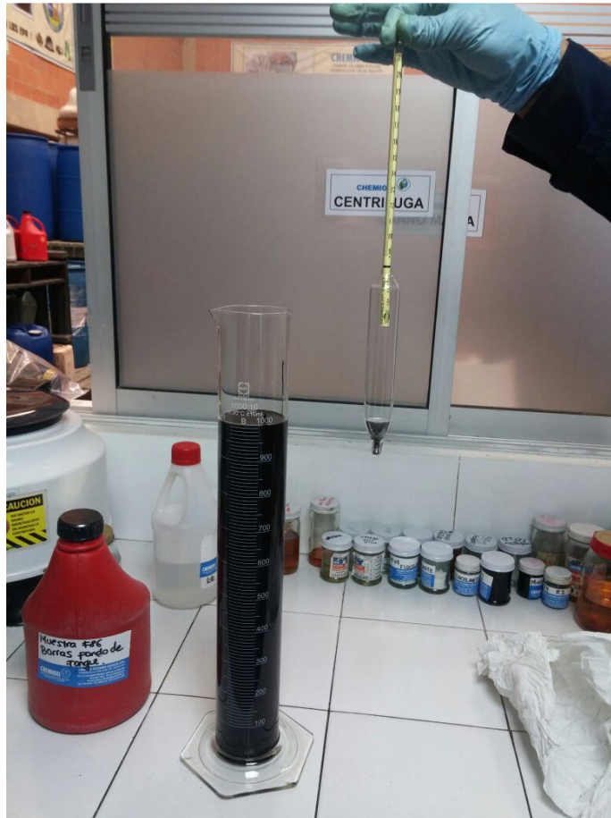
Figura 11. Montaje prueba medición gravedad API mediante hidrómetro.
